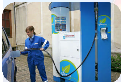
Une station hydrogène alimentant un véhicule équipé d'une pile à combustible
